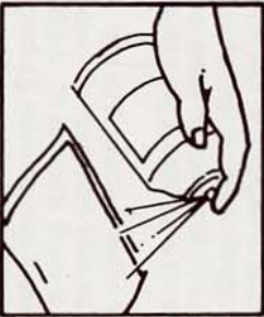
El penetrante se quita de la superficie rotando con tela húmeda con limpiador/removedor
